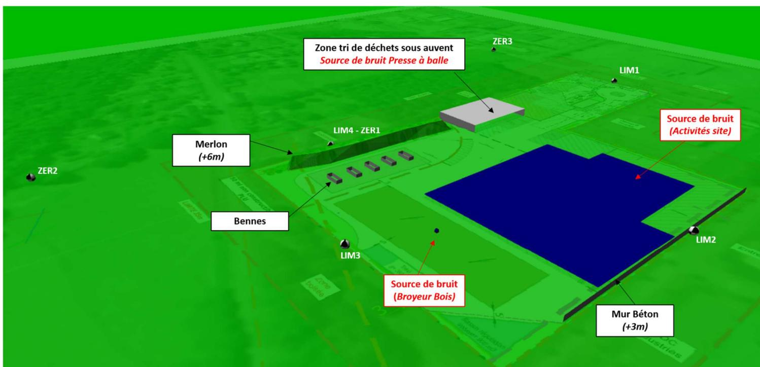
Figure 2 : Vue 3D du site modélisé sous CADNAA (extrait CadnaA)
