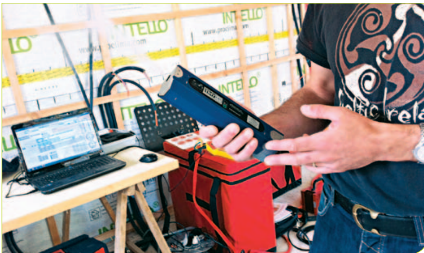
Démonstration d'un test d'étanchéité à l'air pour une maison BBC à Saint-Nicolas-du-tertre.
