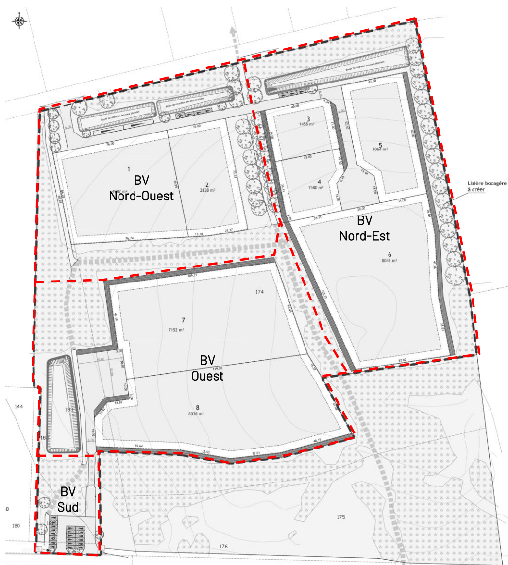
Délimitation des bassins versants projet sur la base du plan masse (source : GBS)
