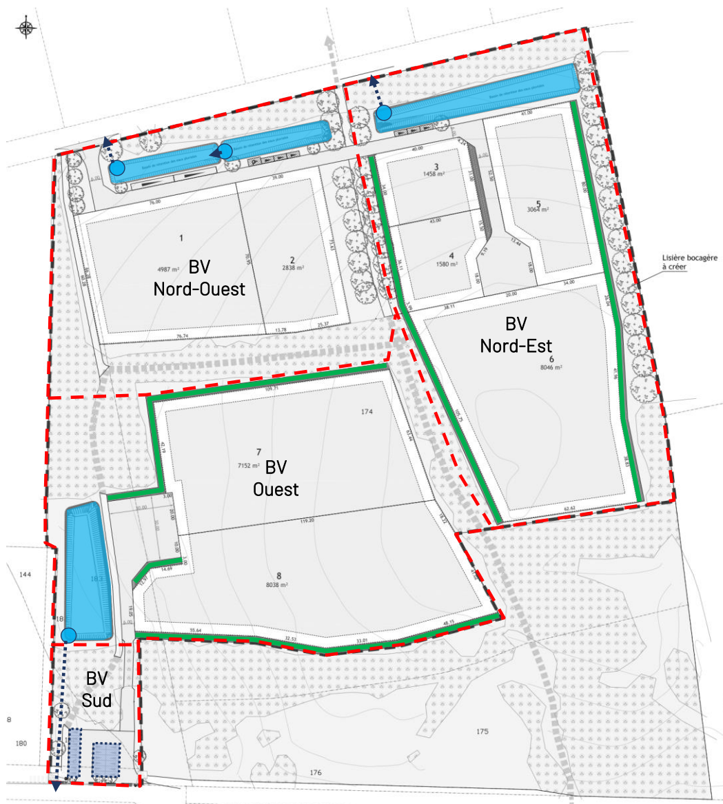
Principes de gestion des eaux pluviales envisagés
