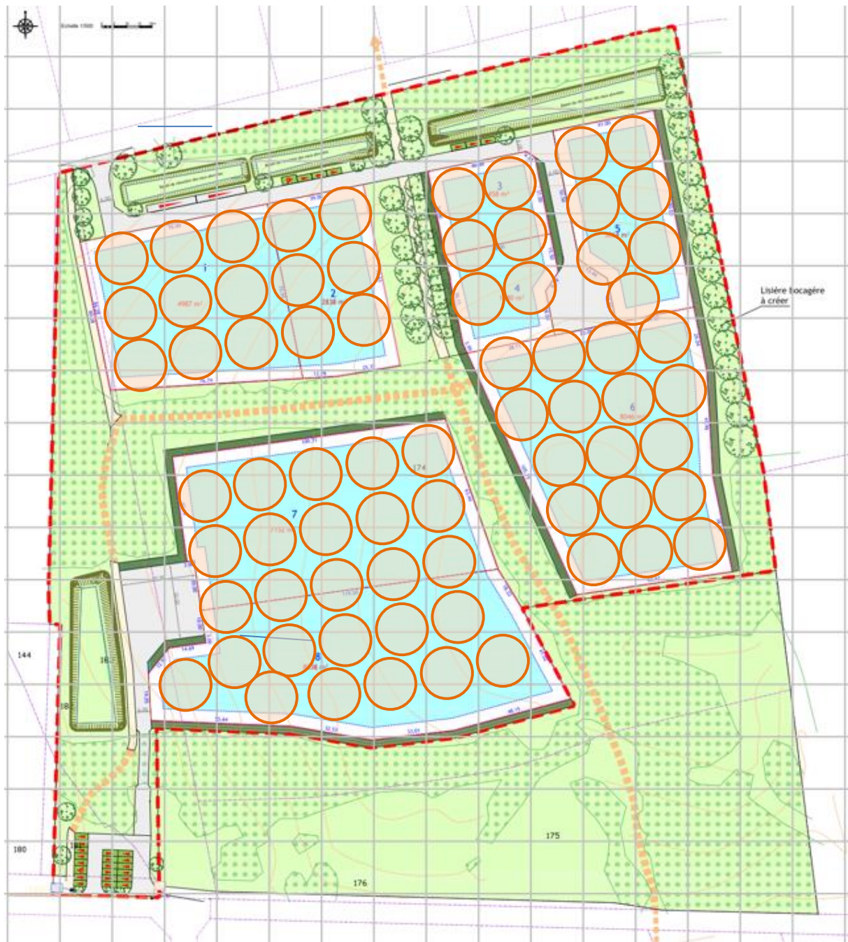
Illustration n°37 : Schéma d'implantation possible du petit éolien sur une trame de 22 m
